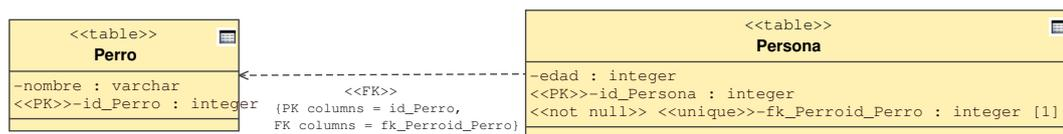
Figura 3.8: Diagrama de clases que representa las tablas de base de datos resultado de la transformación
